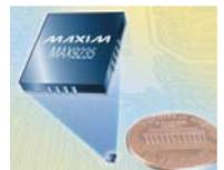
Maxim Integrated Products представил MAX9235 — 10-разрядный параллельно-последовательный преобразователь с быстродействием 400 Мб/с, диапазоном входного сигнала от 16 до 40 МГц и выходом типа LVDS. В совокупности с последовательно-параллельным преобразователем MAX9206 новая микросхема обеспечивает проверенное решение для интерфейсов компактных видеокамер. При габаритных размерах 3x3x0,8 мм 16-выводного кор-
