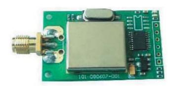
мах малого радиуса действия с двухсторонней передачей данных в безлицензионном частотном диапазоне 433 МГц:
