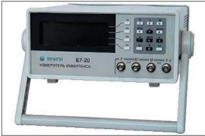
Рис. 4. Внешний вид измерителя иммитанса E7-20
