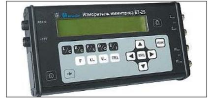
**Рис. 8.** Внешний вид малогабаритного измерителя иммитанса E7-25
