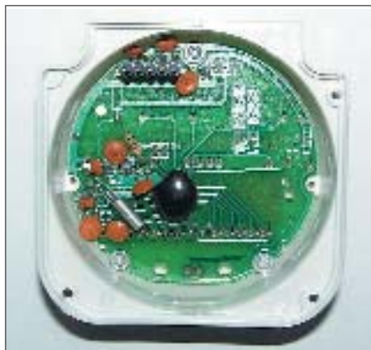
Рис. 3. Печатная плата блока отсчета времени и программирования
