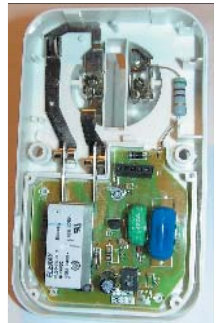
Рис. 2. Вид на внутреннюю начинку цифрового таймера
