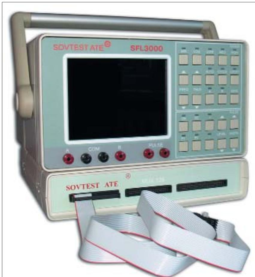
Рис. 1. Локализатор неисправностей SFL3000
