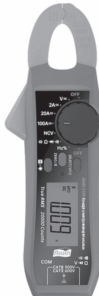
функции TRUE RMS стало уже недостаточно для достижения точности, т. к. синтез частоты сопровождается появлением паразитных ВЧ гармоник, которые оказывают влияние на форму сигнала и точность измерений переменного тока и напряжения.
