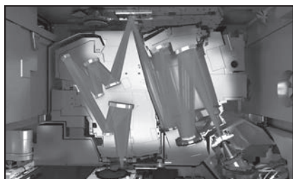
EUV-литография зеркала в литографической машине
