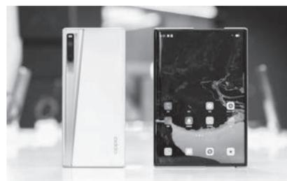
Автоматическое растягивание экрана обеспечивают два миниатюрных электромотора, а OLED-панель загибается на тыльную сторону, что позволяет избавиться от складок, образующихся на смартфонах с раскладывающимися дисплеями.
