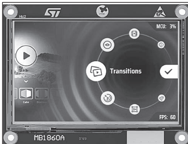
STM32U5G9J-DK2 Discovery kit — полноценная платформа для демонстрации и разработки микроконтроллера STM32U5G9ZJT6Q
