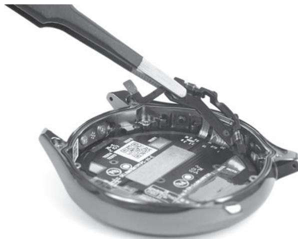
Самой «опасной» для ремонта частью гаджета является модуль подключения аккумулятора к материнской плате через гибкий узел датчика. Так как сам узел жестко закреплен на задней крышке и не разбирается, то его демонтаж вызовет повреждения, требующие последующего ремонта.
